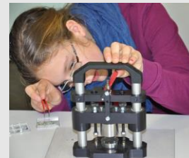
Bild 13: Schülerin beim Erstellen von Mikro-Näpfen an der Mini-MUM
