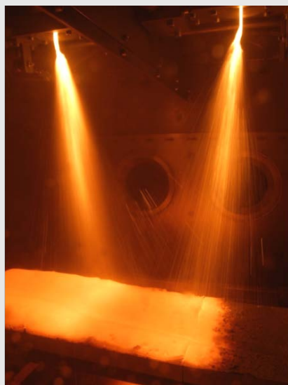
Bild 6: Sprühkompaktieren von gradierten Flachprodukten mit zwei Schmelzen
