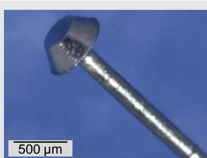
Bild 4: Umformerzeugnis, austenitischer Edelstahl
