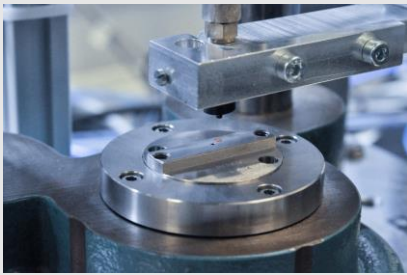
Bild 3: Pneumatischer Greifer zur Positionierung der Mikroronden auf dem Ziehring
