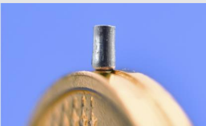
Bild 3: 3-stufigtiefgezogener Napf, Durchmesser 0,75 mm, Edelstahl
