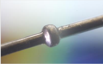
Bild 2: Rundgeknetete Materialanhäufung im Linienverbund, Durchmesser 0,7 mm
